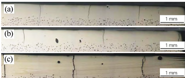
图 3 不同激光扫描速度下铁基合金化层的截面裂纹形貌
